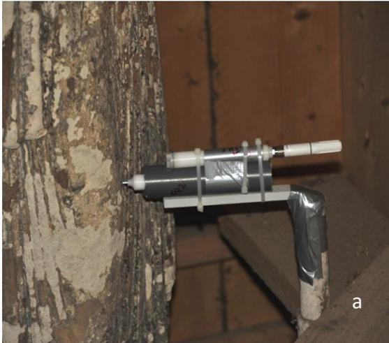
*Autres capteurs de température, d'humidité (triplets température air, température paroi, humidité air) (a) et de confinement (température, humidité, CO<sub>2</sub>) (b) à l'intérieur de la structure.*
