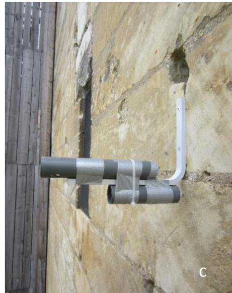
*Les appareils de mesure utilisés ou posés à l'extérieur de la structure bardée : caméra infrarouge pour la thermographie (a), station climatologique (b), capteurs d'humidité et de température (c).*
